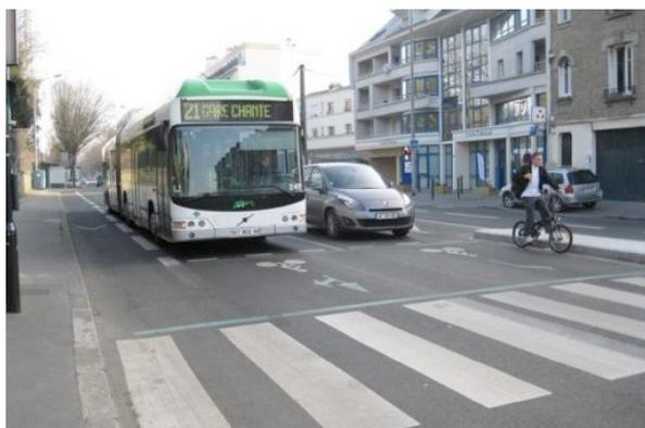
La création d'un sas vélo consiste à marquer en retrait la ligne d'arrêt (ligne d'effet des feux) afin de faciliter l'insertion des cyclistes en carrefour, disposition rendue possible par l'article 415-15 du code de la route.
